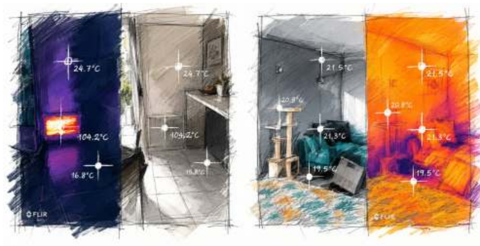
Radiateur électrique classique : Stratification de l'air - Inconfort utilisateur
